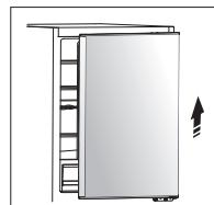
3.Uvolněte šrouby sloužící k upevnění středních dveřních závěsů a vyjměte je.
