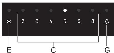
Čísla 2, 3, 4, 5, 6 a 8 označují teplotu ve stupních Celsius ( $^{\circ}\text{C}$ ) v chladicím prostoru.
