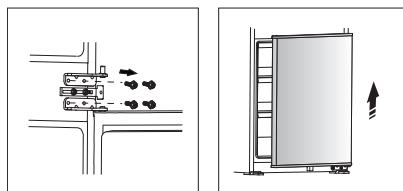
4.Vyměňte kryty otvorů pro šrouby zleva doprava a vyměňte závěsy dveří na opačnou stranu (jak je znázorněno na obrázku níže).
