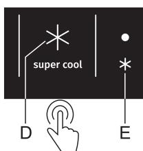
Pro aktivaci funkce intenzivního chlazení (cooling boost) stiskněte tlačítko **D**.
