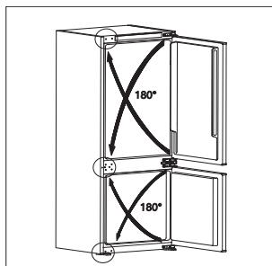
5.Upevněte spodní závěs pomocí šroubů a nasadťte spodní dvířka na čep spodního závěsu a držte je v dané poloze. Upravte střední panty tak, aby byla dvířka správně vyrovnána, a poté je upevněte a ujistěte se, že jsou spodní dvířka zajistěna na svém místě.
