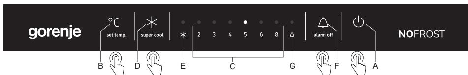
A Tlačítko zapnutí/vypnutí spotřebiče
